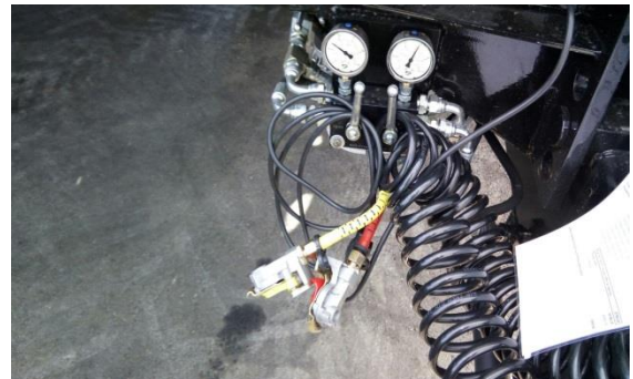
Frein de stationnement pneumatique et freins mixtes
