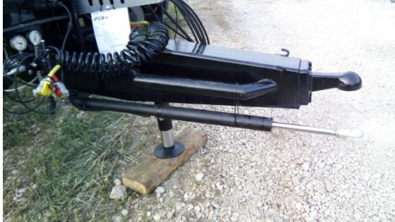
Essieux forcé hydraulique
