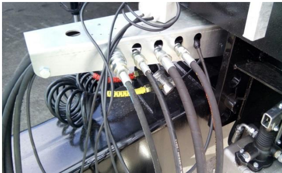
Distributeur électrique 3 éléments, télécommande avec câble
