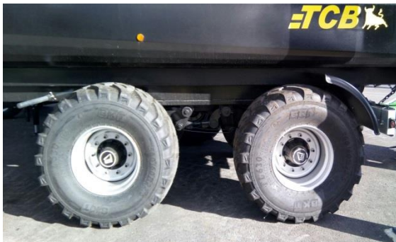
Suspensions avec 1800mm entre essieux
